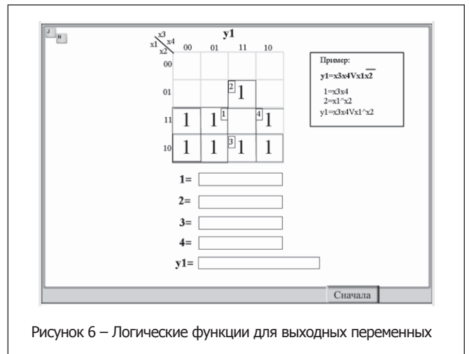
Рисунок 5 – Покрытие единиц на карте Карно
