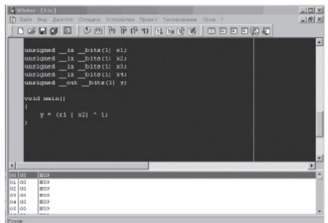
Здесь система отладки Winter взаимодействует с разработанным нами С-компилятором для процессора TCPU.
