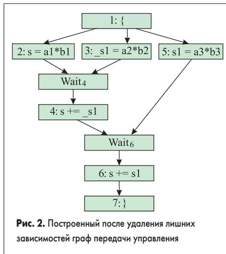
Рис. 2. Построенный после удаления лишних зависимостей граф передачи управления
