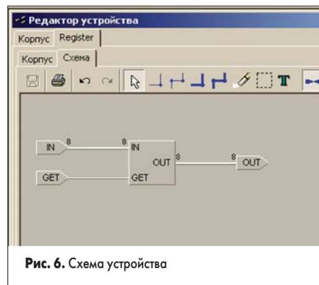
4. В параметрах корпуса (см. на рис. 5 — кнопка «Тип модели») указать имя DLL-файла (в котором находится или будет находиться модель) и имя модели (префикс функции инициализации) (рис. 5). После этого устройство можно использовать как компонент в любых проектах.
