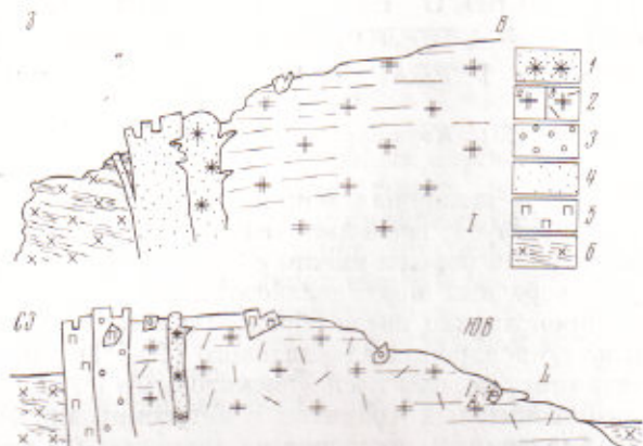
Рис. 2. Схематические разрезы через интрузивы щелочных гранитов Жамансеир (I) и Керегетас (II). 1 — мелкозернистый рибекитовый гранит, 2 — среднезернистый рибекитовый (а) и эгирин-рибекитовый (б) гранит, 3 — синий порфировидный рибекитовый микрогранит, 4 — сине-серый рибекитовый гранит-порфир, 5 — белый гранит-порфир, 6 — гранодиорит
