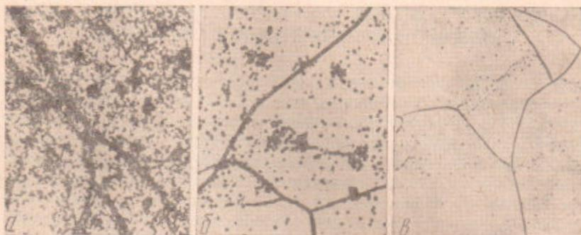
Рис. 2. Субструктура монокристаллов: *a* — молибдена. Его сплавов: *b* — 5 и *c* — 40% Re после 3000 термоциклов. 100×
