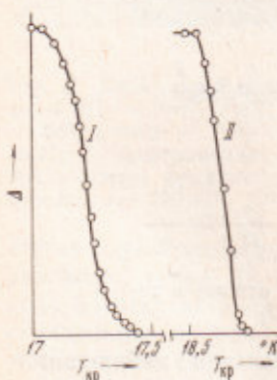
Рис. 3. Кривые перехода в сверхпроводящее состояние соединения Nb 3 Al: I — литое состояние; II — отжиг при 700° в течение 2 суток
