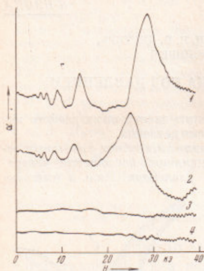
Рис. 2. Коэффициент поглощения звука \alpha в магнитном поле при давлениях: 1 — 0; 2 — 2 кбар; 3 — 4 кбар; 4 — 6 кбар
