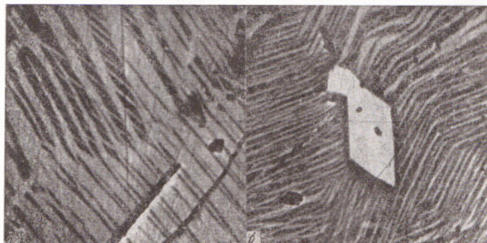
Рис. 1. Тонкопластинчатая структура сростаний свинцовой (светло-серое) и сурьмянистой (черное) фаз в образце рамдорита. В центре шлифа б — кристалл ромбического сечения — плагионит. Снято в обратно-рассеянных электронах, 960 \times
