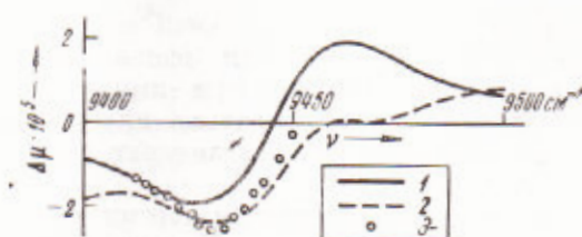
Рис. 2. 1 — отрицательная дисперсия для линии 9447 см -1 по (3); расчетные (2) и экспериментальные (3) значения отрицательной дисперсии двуупреомления.
