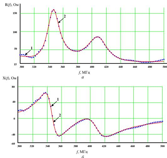
Рисунок 1 – Зависимость изменения активной (а) и реактивной (б) части импеданса АУ
