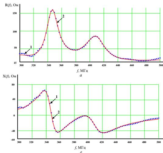
Рисунок 1 – Зависимость изменения активной (а) и реактивной (б) части импеданса АУ AD-25/CW-3512 в рабочей полосе частот ( $\Delta f = 200$  МГц):
