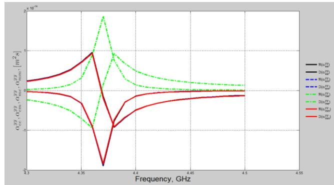
Рисунок 3 – Графики частотной зависимости действительной и мнимой частей поляризумостей планарной спирали
