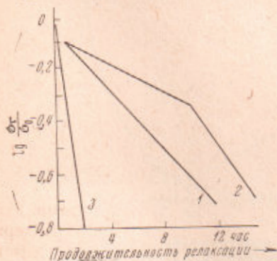
Рис. 1. Кинетика релаксации напряжения пленок из хлоропренового латекса при 120° С. Удлинение \varepsilon = 50\% . Пленка, в которую противостаритель введен набуханием в его растворе (1) и на стадии латекса в виде дисперсии (2), пленка, не содержащая противостаритель (3)
