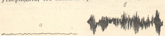
Рис. 3. Осциллограмма изменения силы трения при испытании кобальта: а — 360°; б — 430°
