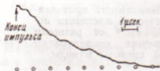
Рис. 1. Оциллограмма спада оптического поглощения  $e_s^-$  при 650 мμ в метаноле, содержащем 0,1 мол/л КОН и  $5 \cdot 10^{-4}$  мол/л  $NO_2^-$ , после прохождения импульса электронов длительностью  $\sim 2,2$  мсек (доза за импульс  $\sim 3 \cdot 10^{17}$  эв/мл). Расстояние между точками равно 1 мсек.
