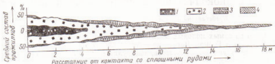
Рис. 2. Изменение состава, строения и средней мощности прожилков в штокверке по мере удаления от контактов с массивными колчеданными рудами. 1 — FeS, 2 — FeS 2 , 3 — SiO 2 и хлорит, 4 — карбонат
