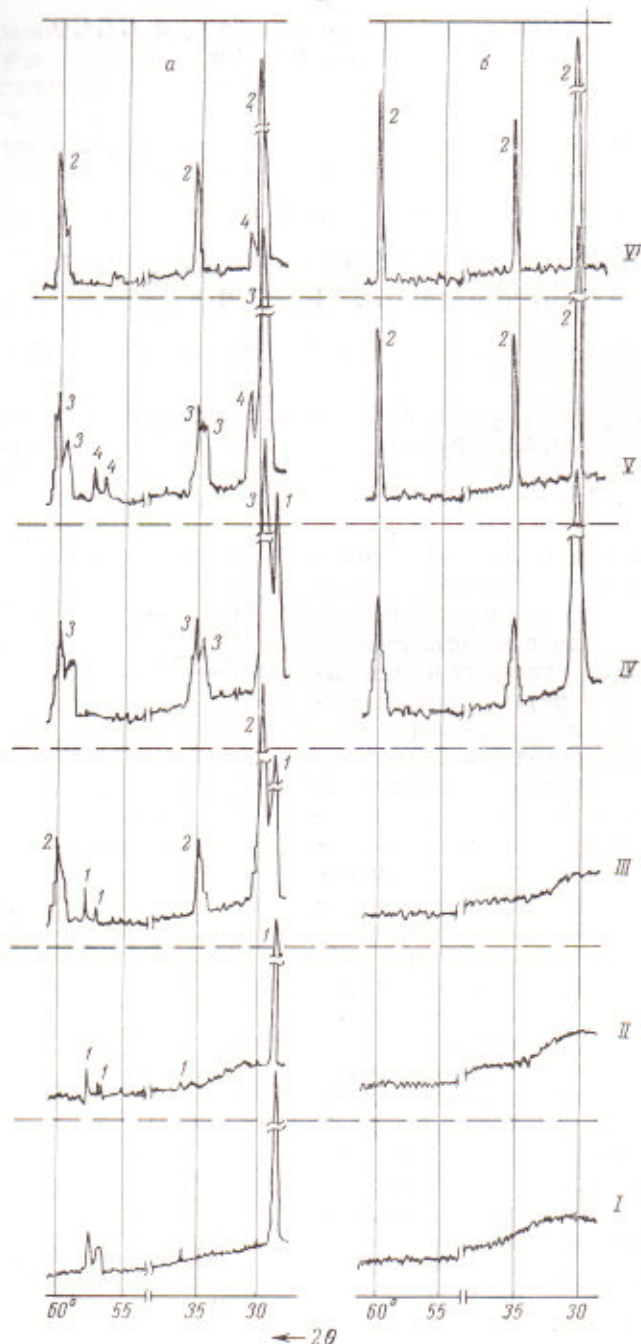
Рис. 2. Высокотемпературный рентгенофазовый анализ. a, б — то же, что на рис. 1. I, II, III, IV, V, VI — рентгенограммы, записанные при температурах 20, 380, 420, 520, 700 и 1000°. 1, 2, 3, 4 — принадлежность линий фазам: кальциту, кубической ZrO_2 , тетрагональной ZrO_2 , CaZrO_3 соответственно
