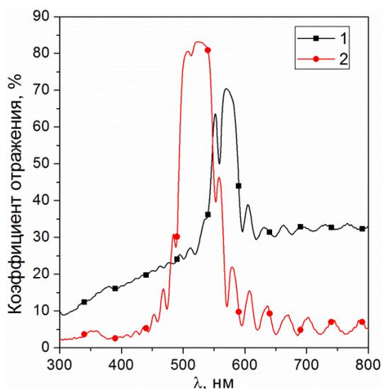
а) спектры зеркального отражения образцов ФК при угле падения  $10^\circ$  на алюминии (1) и отделенного от алюминия (2);
