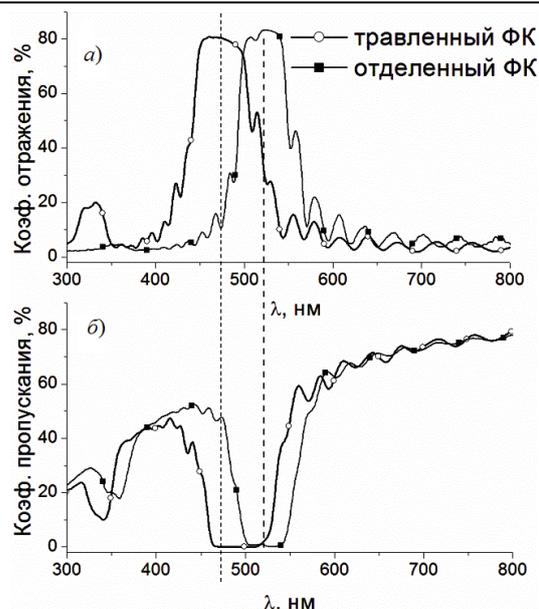
Рисунок 2.3 – Спектры зеркального отражения при угле падения  $10^\circ$  (а) и пропускания (б) образцов ФК
