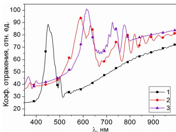
Рисунок 2.5 – Спектры зеркального отражения ФК структур с  $Q$  0,44 Кл/см<sup>2</sup> (1), 0,59 Кл/см<sup>2</sup> (2), 0,66 Кл/см<sup>2</sup> (3)
