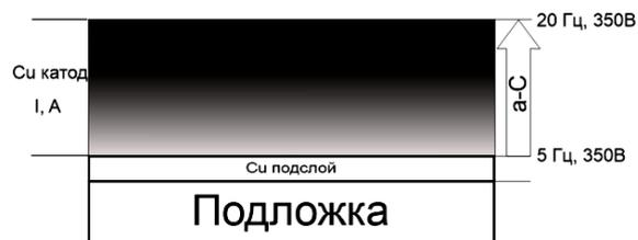
Рисунок 1.1 – Схематическое изображение медь-углеродного покрытия, осажденного на медный подслои
