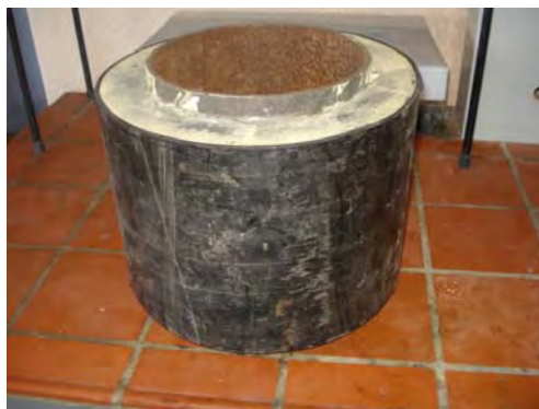
Рис. 8. Образец трубы для испытания на сдвиг
