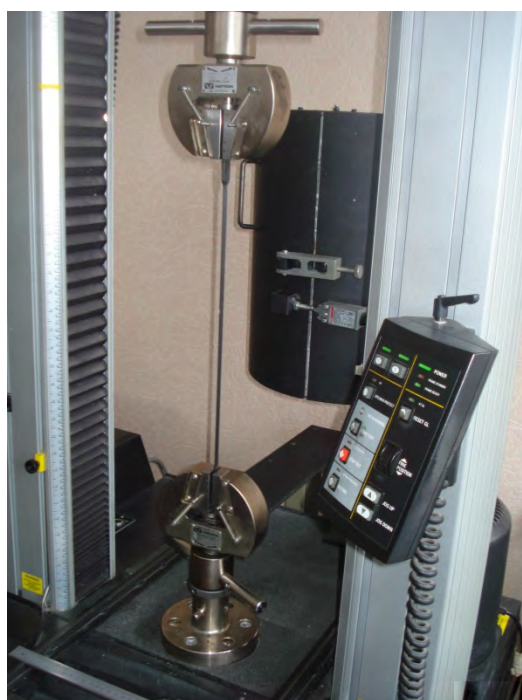
Рис. 11. Испытание на растяжение образцов из оболочки ПИ-трубы
