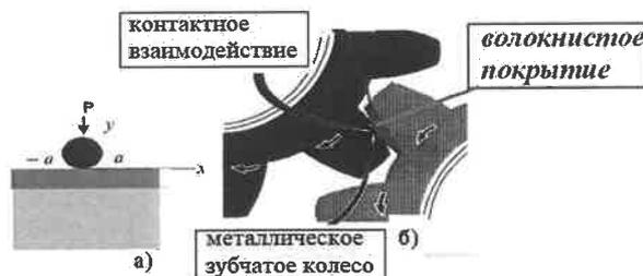
Рисунок 1 – Схема, моделирующая контакт зубьев с покрытием
