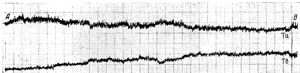
Рис. 2. Концентрационные кривые тантала и ниобия. Линейное профилирование. Шкала интенсивностей 3 \cdot 10^3 . Скорость движения бумаги 300 мм/час. Скорость перемещения образца 20 м/мин
