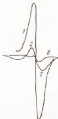
Рис. 1. Спектры э.п.р. при различной скорости работы дезинтегратора: 1 — максимальная (скорость соударяющих с я частиц песка достигала 270 м/сек); 2 — 0,8 от максимальной; 3 — 0,6 от максимальной
