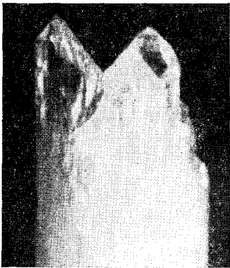
Рис. 2. Кристаллы сподумена. Парастание прозрачных вершин на затравку природного сподумена. 10×
