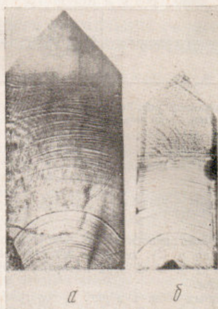
Рис. 3. Теневые проекции образца искусственного флюорита, полученные на установке УИГ-2 (а) и установке со светящейся точкой (б)
