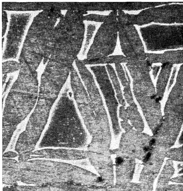
Рис. 1. Видманштеттенова структура. Сечение, близкое к (112). «Балки» камасита окружены светлой каймой тэнита, средние участки фигур заняты плесситом. 18×. Репрод. 4 : 5
