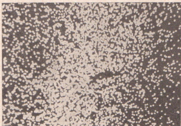
Рис. 1. Участок аншлифа пандайта в характеристическом рентгеновском излучении бария при сканировании зондом; видно неравномерное распределение бария (белые точки). 300X
