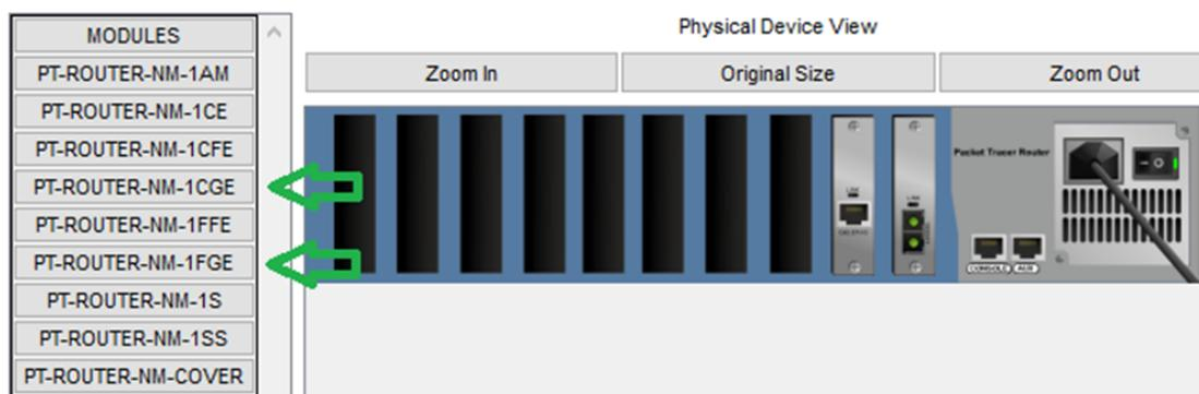
Рисунок 2 – Запланированные интерфейсы для работы сетевых устройств
