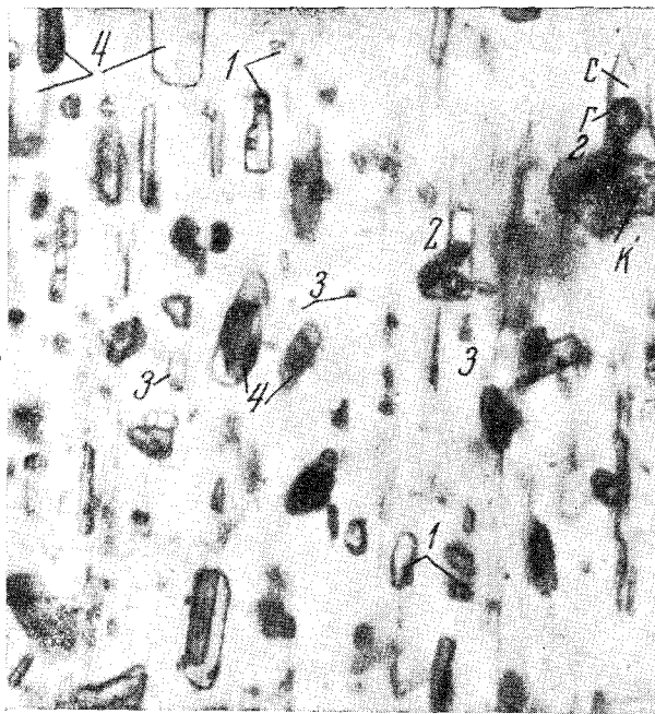
Рис. 1. Включения в зерне нефелина. 1 — комбинированные, 2 — раскристаллизованные, 3 — жидкие включения, 4 — пойкилитовые вросстки. Заметна ориентированность в расположении включений, параллельная главной кристаллографической оси нефелина. С — стекло, Г — газовая фаза, К — кристаллическая фаза. Шлиф № 194. 525 \times
