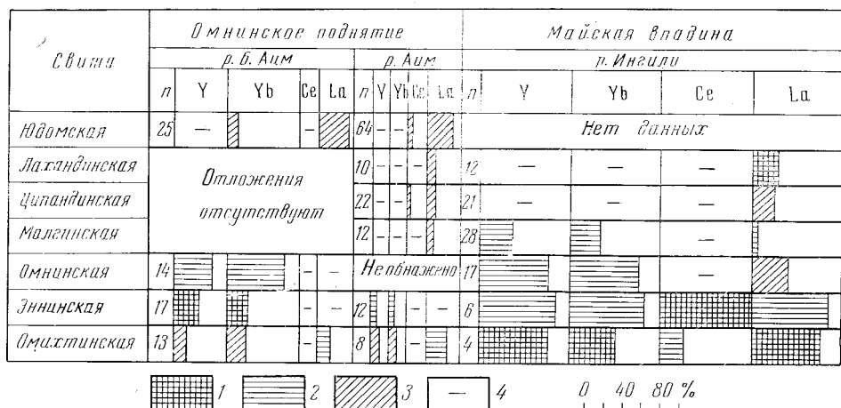
Рис. 1. Частота встречаемости (%) и кларковые уровни Y, Yb, Ce и La в отложениях нижнего и среднего рифея и венда восточного склона Алданского щита. 1 — вышекларковые, 2 — кларковые и редко вышекларковые, 3 — нижекларковые и следы, 4 — не зафиксировано (n — число анализов)
