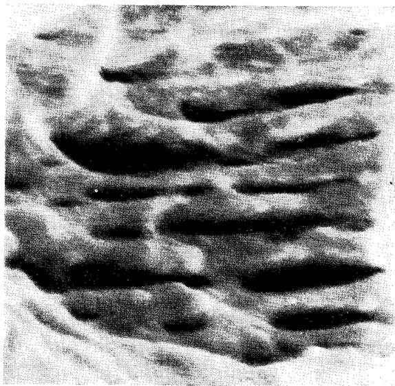
Рис. 1. Стрoение поверхности участков глубокого травления молибдошеелита
