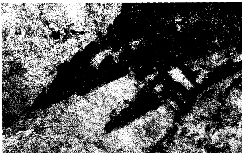
Рис. 3. Ангидрит пелитоморфной структуры с участками реликтовой пластинчатой, псевдоморфно замещающей гипс. Дегидратация прошла полностью, первичный гипс улавливается только по контурам верхушек кристаллов на контакте с мелкозернистым известняком. Темное — известняк, светлое — ангидрит. Язовское месторождение серы. 80 \times . Ник. +
