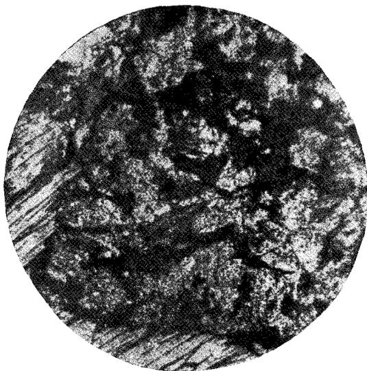
Рис. 2. Замещение кариоцерита ортитом, 90 ×. Без анализатора
