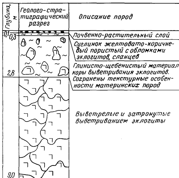
Рис. 2. Разрез участка обнаружения алмаза по данным документации шурфа
