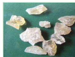
Рис. 1. Внешний вид образцов экспериментальной партии. Размеры кристаллов ~ 2—7 мм
