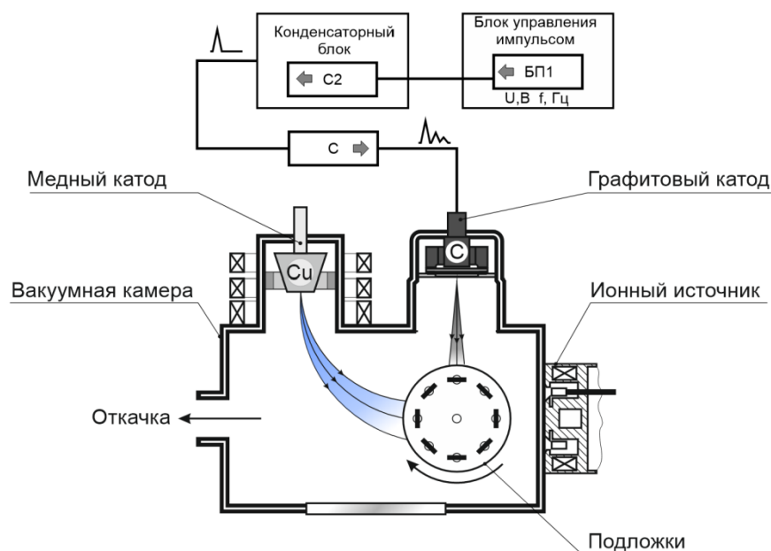
Рис. 1. Схема осаждения покрытий из совмещенных потоков медной и углеродной плазмы
