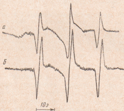
Рис. 1. Спектры э.п.р.: a — «спин-меченый» ингибитор, связанный с \alpha -химотрипсином; б — то же в присутствии бензамида
