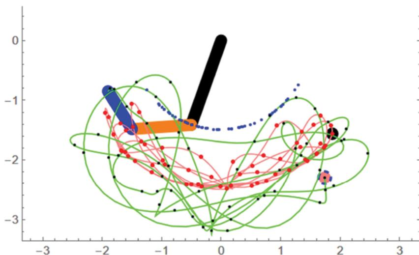
Рис. 5. Графическое отображение решения уравнений движения системы из трех маятников с помощью Manipulate
