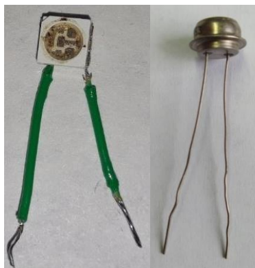
Рисунок 2 – Заготовка (макет фотодиода) и корпусированная структура (готовый УФ-датчик)
