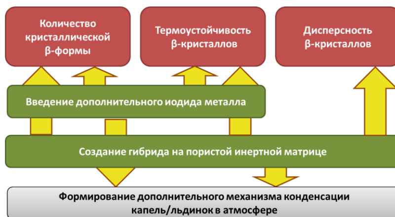
Рисунок 1 – Схематическое изображение взаимосвязи свойств гибрида и параметров синтеза
