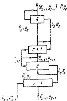
Рис. 1. Каскад с двухфазными разделительными элементами
