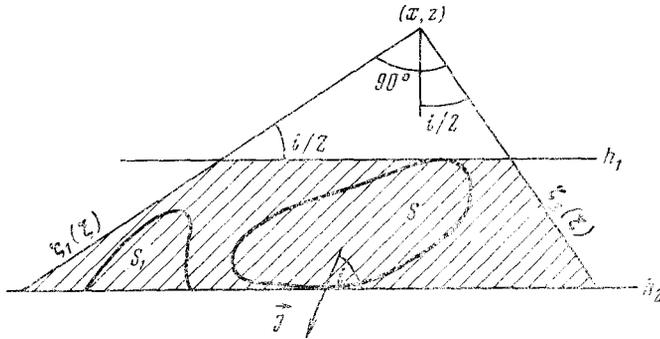
Рис. 1. Тело, создающее максимальную аномалию в точке  $(x, z)$  при заданных  $\vec{J}$ ,  $h_1$ ,  $h_2$  (заштриховано)
