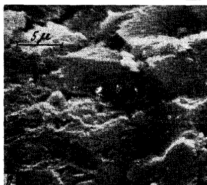
Рис. 1. Структуры цементного камня различных сроков твердения (в сутках): а — 2, б — 14, в — 3,5 мес.; а, в — 3000\times б — 10\,000\times
