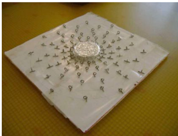
Рис. 1.7. Экспериментальный макет маскирующего устройства на основе канонических спиралей [113]
