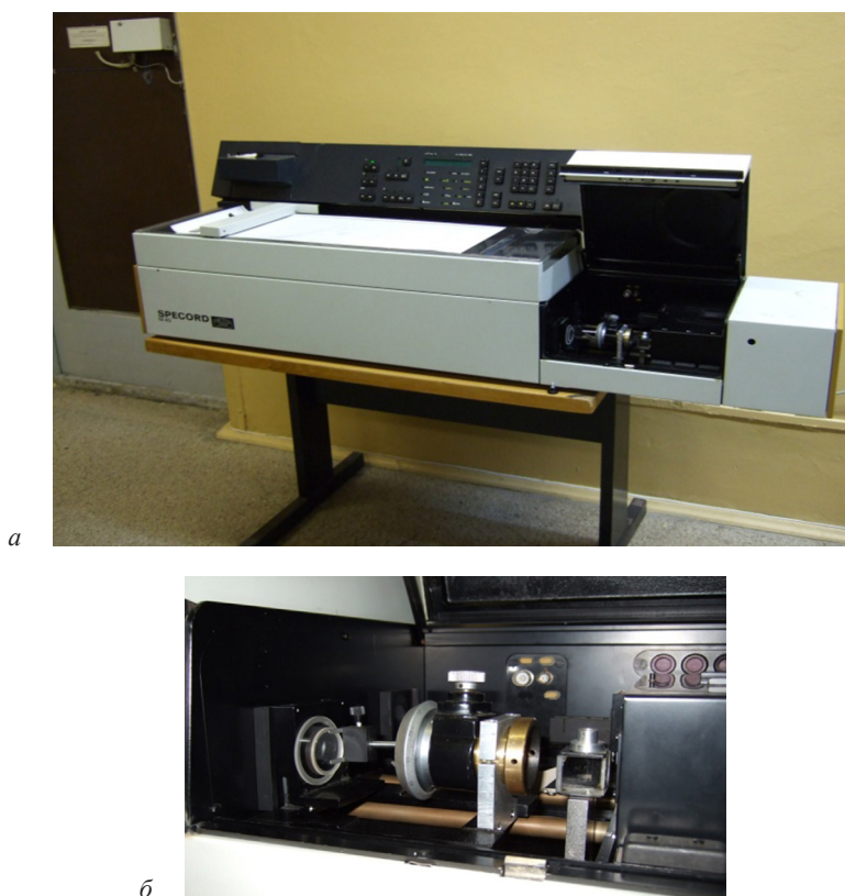
Рис. 2.40. Спектрофотометр Specord M 40: а – внешний вид; б – фото одного из каналов спектрофотометра
