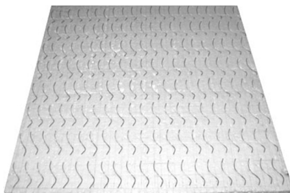
Рис. 4.4. Искусственный образец, содержащий правосторонние одновитковые спирали с углом подъема 53^\circ \pm 3^\circ
