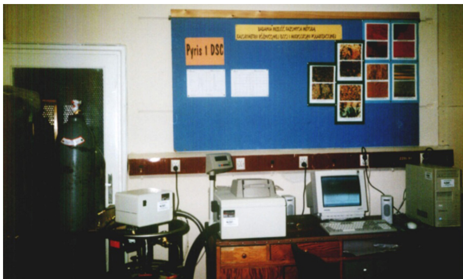
Рис. 2.31. Общий вид экспериментальной установки Института физики Ягеллонского университета (г. Краков, Польша): дифференциальный сканирующий калориметр Pyris 1 DSC (в центре), установка для термального анализа CryoFill с баллонами жидкого азота (слева), управляющий компьютерный терминал (справа)
