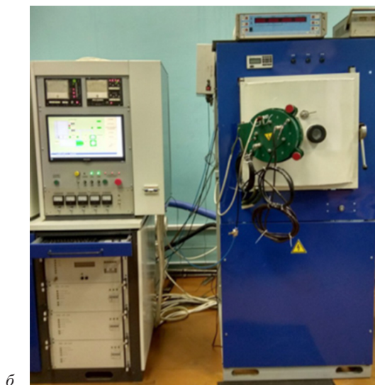
Рис. 2.5. Процесс изготовления маски (а) и вакуумная камера для магнетронного распыления (б)
