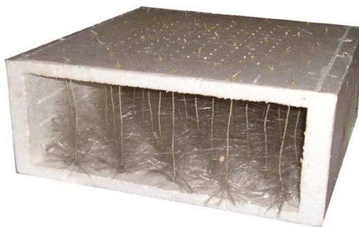
Рис. 2.20. Пенопластовый блок, содержащий конусовидные «елочки» из стекловолокна
