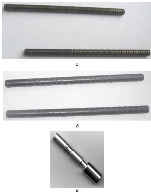
Рис. 2.1. Фотографии шаблонов для изготовления спиральных элементов с разными углами подъема ( a - 7,1^\circ ; б - 13,6^\circ ; в - 53,0^\circ ): a, б – для наливки право- и левосторонних спиралей; в – для наливки правосторонних спиралей
