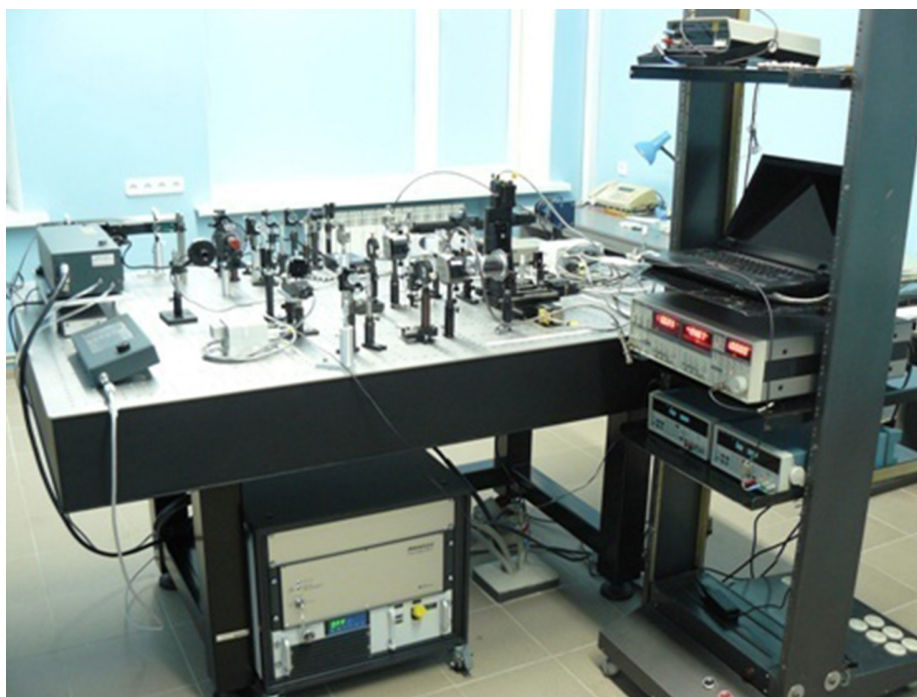
Рис. 2.30. Терагерцовый лазерно-оптический стенд, созданный в Институте физики имени Б. И. Степанова НАН Беларуси
