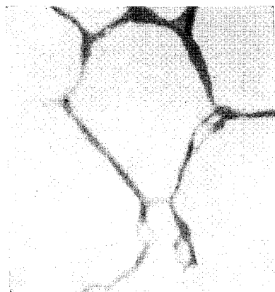
Рис. 2. Микроструктура шлифа \text{ZrO}_2 с 4,5 мол. % \text{Y}_2\text{O}_3 после обжига при 2000^\circ в течение 45 мин. (680 \times )
