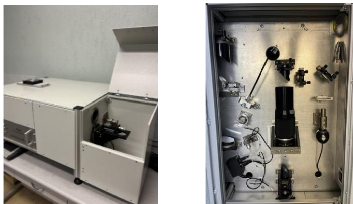
Рисунок 2 – Внешний вид и оптическая схема ЛАЭМС спектрометра
