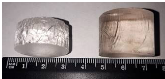
Рис. 2. Образцы кварцевого стекла, полученного золь-гель методом
