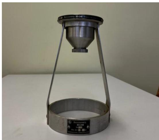
Рисунок 3 – Прибор вискозиметр ВЗ-246 (фото Н. А. Щеглова)
