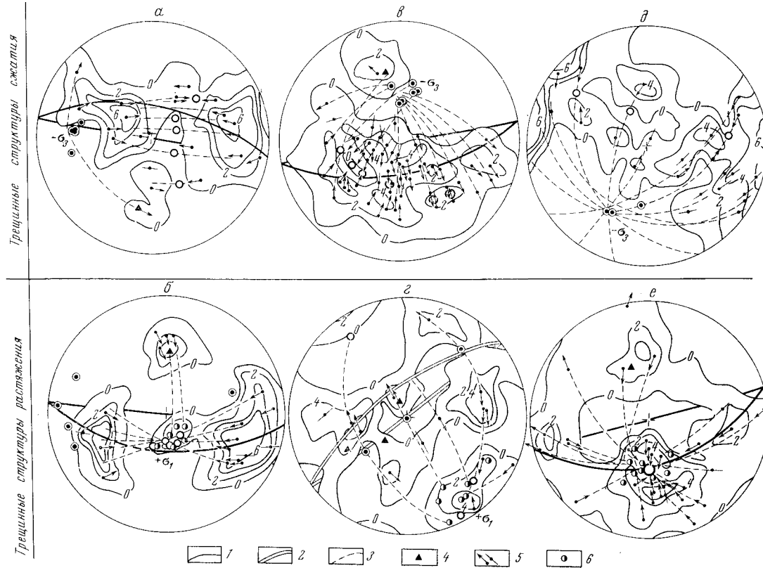
Рис. 2. Кинематические типы диаграмм полюсов тектонической трещиноватости (а, в, д — трещинные структуры сжатия, б, г, е — растяжения): а (82 трещины), б (86 трещин) — типы взбросовой трещиноватости известняков C_{1-2} района Чарвакской ГЭС (р. Чирчик); в (97 трещин) — трещиноватость известняков C_1 верховья Дара-Об (хребет Петра I); г (68 трещин) — гипсов J_3 руч. Руноу (хр. Петра I); д (124 трещина) — гранитов C_{2-3} Чаткальского батолита, руч. Терс у пос. Кытай (Зап. Тянь-Шань); е (112 трещин) — песчаников кызылташской свиты C_1 верховья р. Дара-Об. 1—3 — след плоскостей на верхней полусфере: 1 — напластования, 2 — крупного тектонического разрыва, 3 — кинематических плоскостей отдельных сколовых нарушений при известной ориентировке относительного перемещения крыльев; 4 — полюса поверхности напластования; 5 — полюса сколовых нарушений и ориентировка кальцитовых борозд скольжения с определенным направлением относительного перемещения крыльев (а) и с неопределенным (б); 6 — полюса трещин отрыва. Остальные обозначения те же, что на рис. 1
