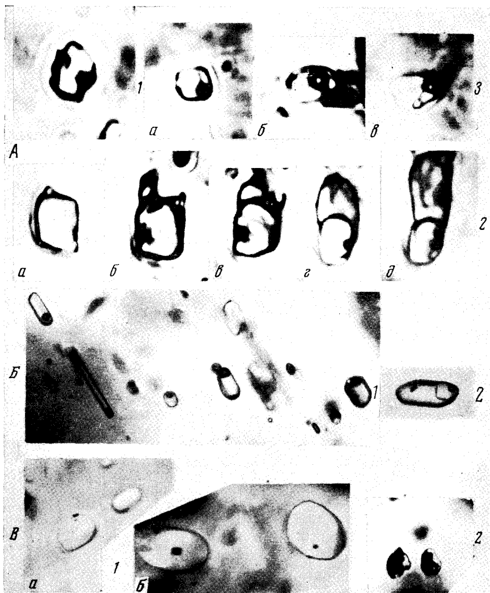
Рис. 1. А — первичные включения расплава в апатите (2200×): 1 — двухфазовое (стекло + газ), снято при комнатной температуре; 2 — однофазовое («закаленное» стекло), изменение формы и размеров полости включения при нагревании (а — снято при комнатной температуре, б — при 950°, в — при 1000°, г — при 1060°, д — в момент гомогенизации при 1140°); 3 — двухфазовое (стекло + газ), изменение формы и размеров полости включения при высокой температуре (а — снято при 880°, б — при 1070°, в — при 1100°). Б — вторичные включения в апатите. Снято при комнатной температуре (900×): 1 — газовой-жидкие; 2 — газовой-жидкие с твердой фазой. В — включения расплава в оливине, снято при комнатной температуре (790×): 1 — стекловатые (а — однофазовые («закаленное» стекло), двухфазовые (стекло + газ), б — двухфазовые (стекло + газ)); 2 — раскристаллизованные (стекло + кристаллическая фаза + газ)
