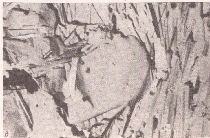
Рис. 1. а — шлиф центральной части таблетки, сечение параллельно осевому давлению, 150\times : белое — кварц, серое — остальные минералы, интенсивное рассланцевание; б, в — образец под электронным микроскопом: б — сечение перпендикулярно осевому давлению; кристаллы фторталяка, 30\,000\times , в — сечение параллельно осевому давлению, порфиробласт кварца, «обтекаемый» кристаллами фторамфбола, 27\,700\times
