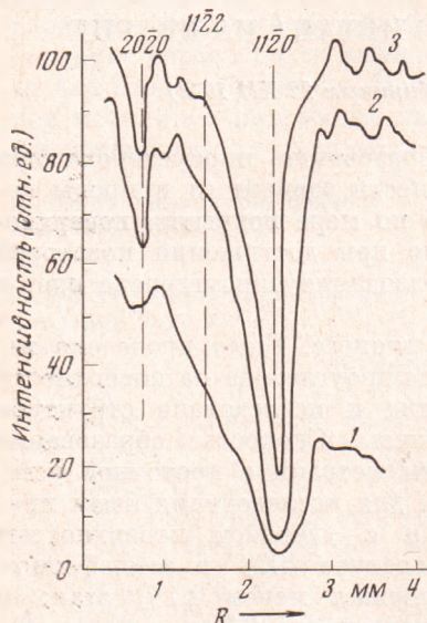
Рис. 1. Изменение формы линий пироуглерода в зависимости от толщины осадка, h_c . 1 — h_c = 30 , 2 — 100, 3 — 2000 Å
